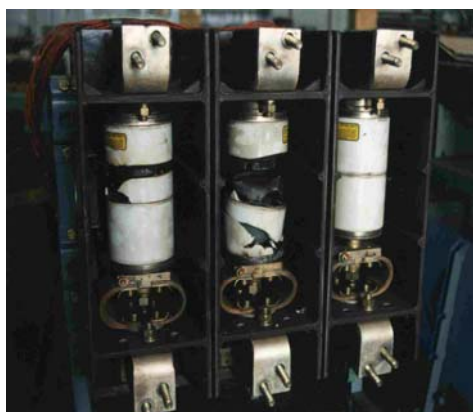
Slika 10. Vakuumski prekidači s razorenim komorama nakon neuspjelog gašenja luka u procesu sklapanja
