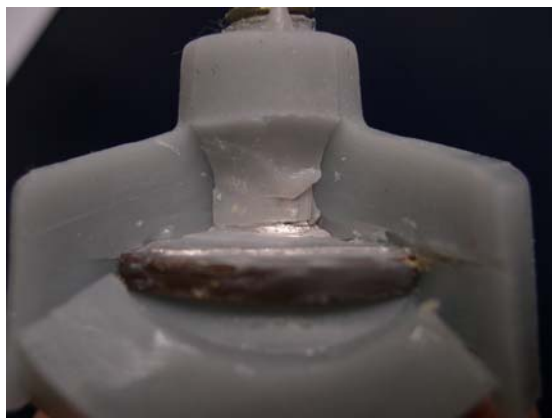
Slika 4. Presjek ispitivanoga NN odvodnika prenapona zalivenog silikonskom gumom
