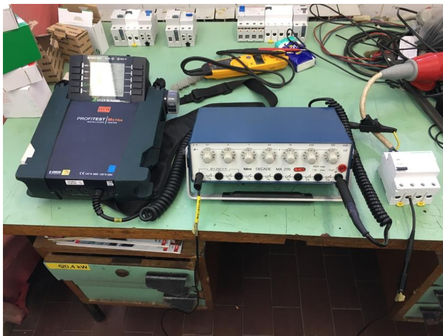
Slika 5. Ispitno okruženje za ispitivanje RCD-a pri različitim vrijednostima impedancije petlje kvara
