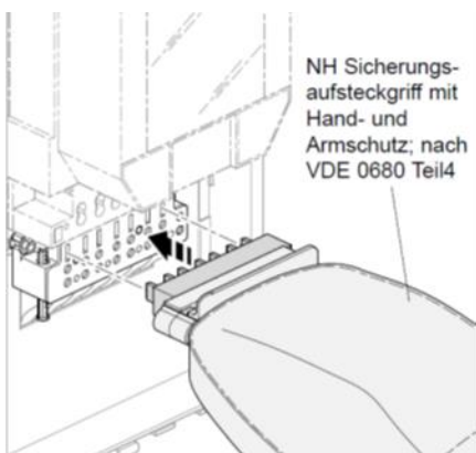
Slika 13 i 14: Postavljanje prenosnice (kratkospajča)
