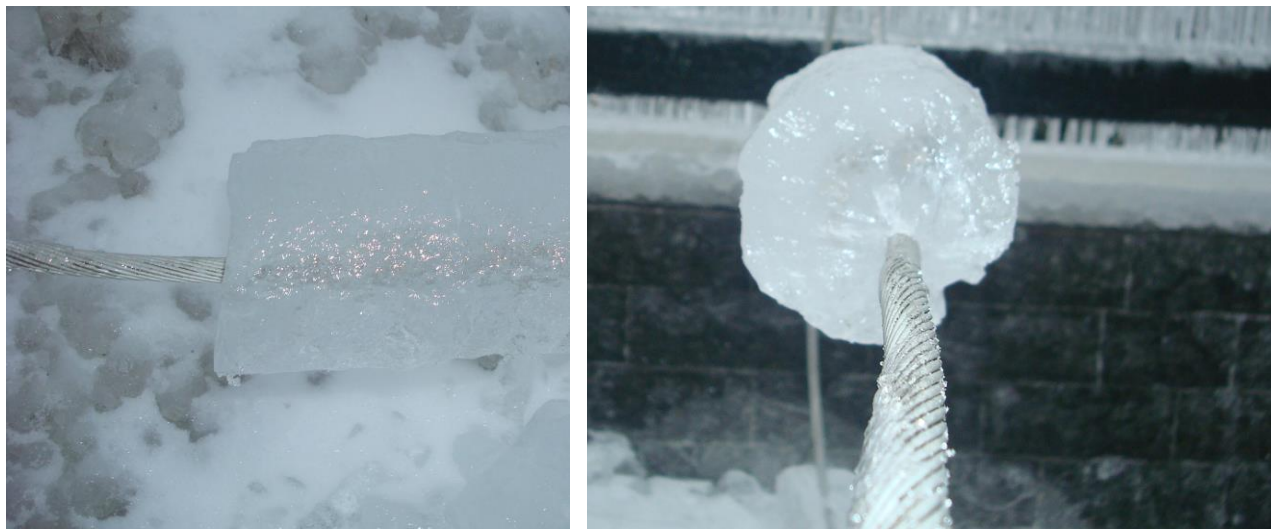
Slika 2. Sloj leda oko vodiča uslijed ledene kiše
