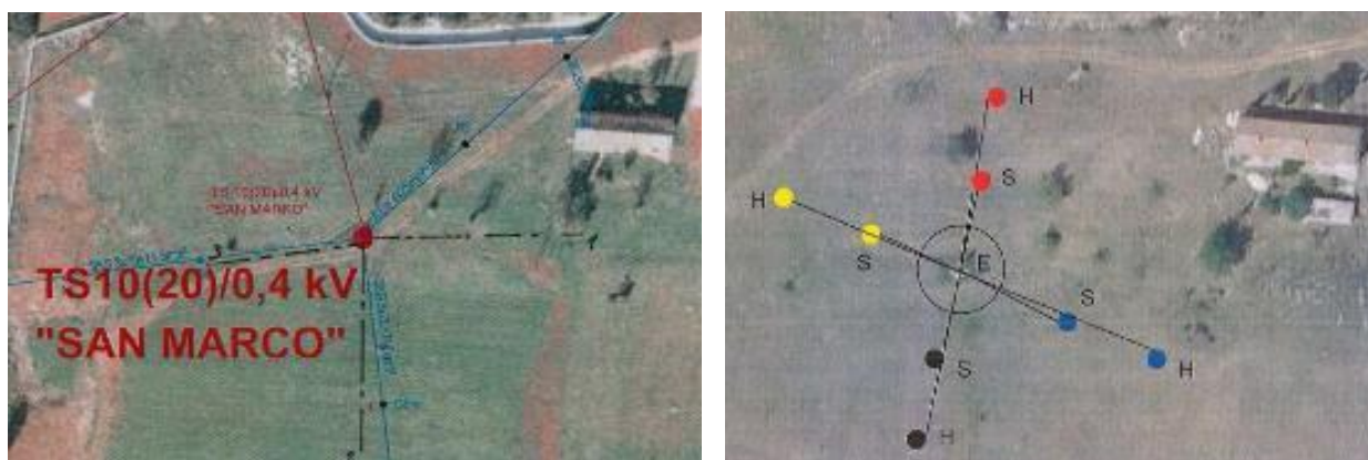
Slika 13-14. Lokacija novih inox traka (crtkano) i pozicije sonde (mjerenja) TS SAN MARCO
