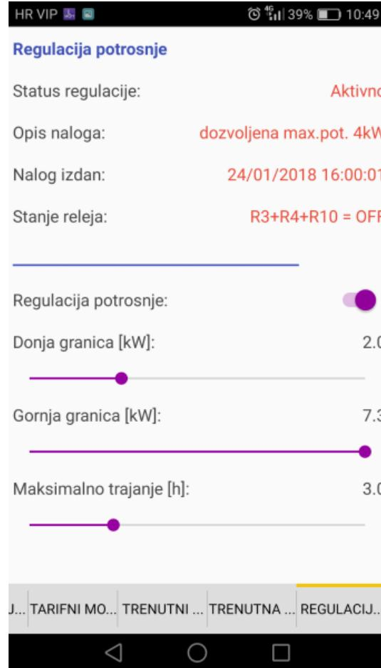
Prednost razvijenog sustava očituje se u modularnosti te primjenjivosti na veliki broj postojećih brojila uz njihove manje modifikacije:
