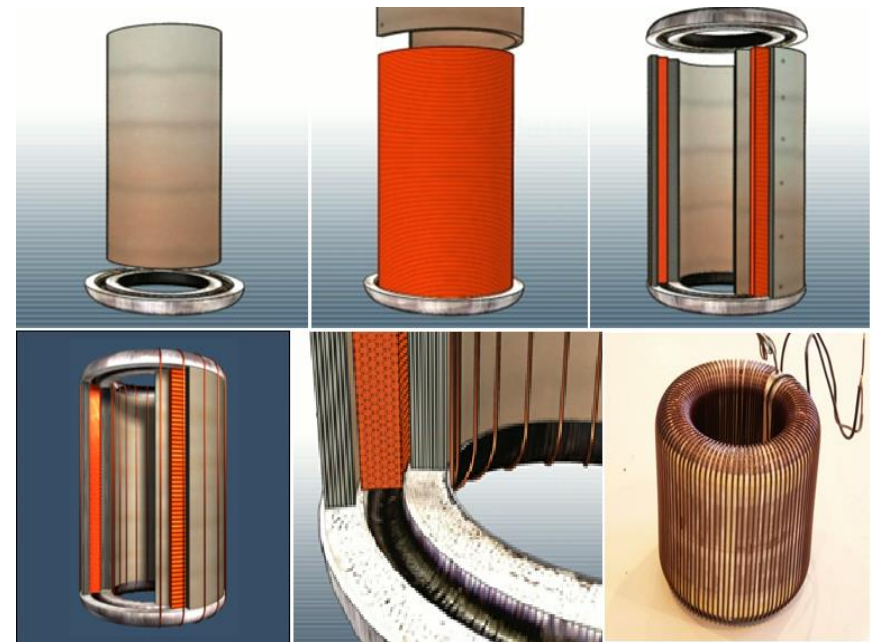
Slika 3. Koraci izgradnje prigušnice s promjenjivim induktivitetom
