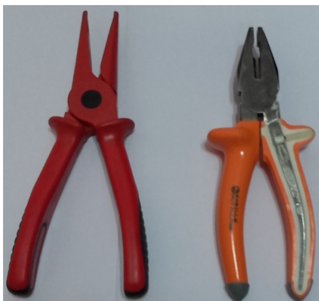
Slika 1. Izolacijski i izolirani alat za rad pod naponom
