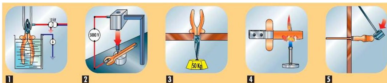
Slika 2. Vrste ispitivanja izoliranog alata za rad pod naponom tijekom proizvodnje
