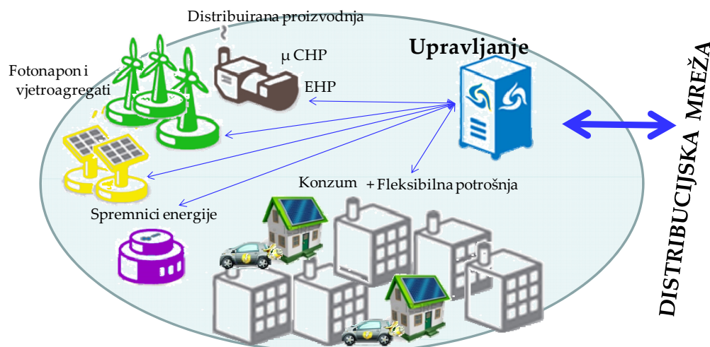
Slika 1 Elementi mikromreže te potencijal spajanja mikromreže kao fleksibilnog čvorišta na distribucijsku mrežu preko jedne točke
