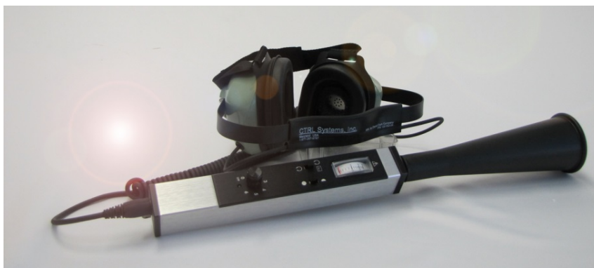
Slika 19. Uređaj za ultrazvučnu detekciju ( slika vlasništvo CTRL Systems, Inc.)
