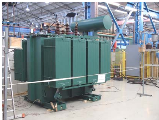
Slika 7. Prototip transformatora 8 MVA sa ekspanzionim hladnjacima
