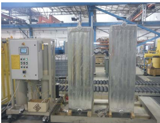
Slika 1. Mjerenje elastičnosti ekspanzionog hladnjaka
