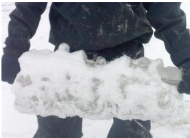
Slika 8. Ledeni oklop na faznom vodiču DV 110 kV Cerkno - Idrija [15,16]
