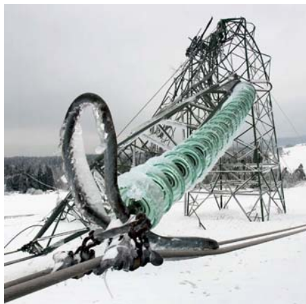
Slika 7. Havarija 400 kV DV stupova [15,16]
