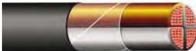
Slika 3.: 4-žilni NN kabel sa sektorski oblikovanim višežičnim vodičima od bakra
