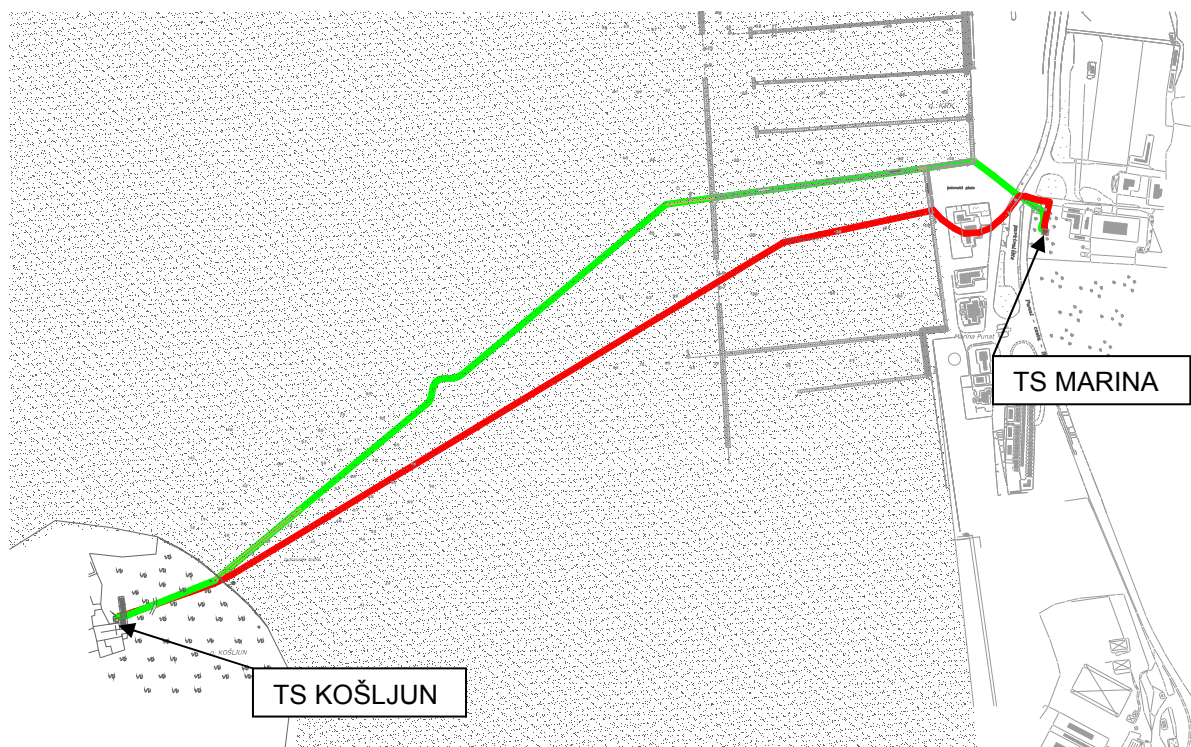
Slika 3. Trase postojećeg (označen crvenom bojom) i novog (označen zelenom bojom) podmorskog kabela za otok Košljun
